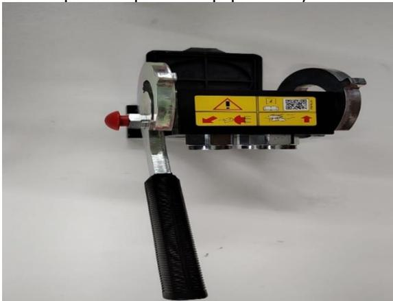
Lateral do engate rápido hidráulico da máquina
