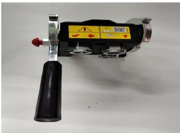
Engate rápido hidráulico da máquina
