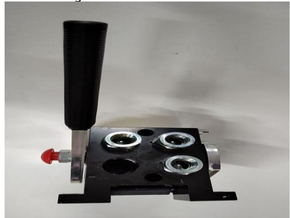
Frontal do engate rápido hidráulico da máquina
